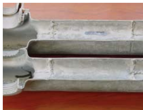
радиатор после 2000 часов Salt Spray тестирования
